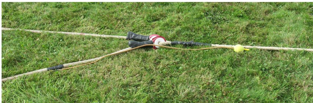
Das Gummiseil kann um 100%, also auf die doppelte Länge ausgestreckt werden. Nach 100% wird jede weitere Ausdehnung blockiert.
