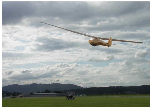
**Hier sind die Bilder zum Vergleich geringer Zugkraft eines Gummiseils für Starts von einem steilen Hang und die kräftigen Gummiseil, das in der Schweiz verwendet wird :**
