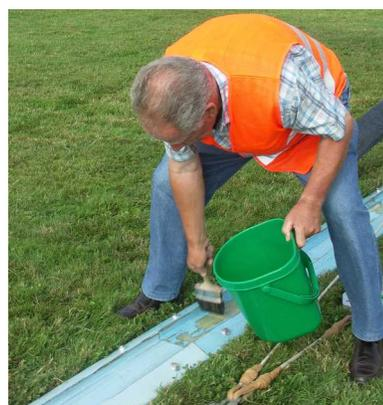
Die Schiene wird mit Schmierseifenwasser eingebürstet um das Gleiten des Segelflugzeuges auf der Starttrampe zu verbessern.
