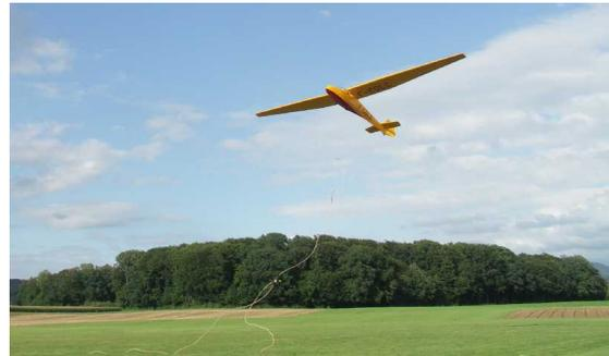
Wie in der Vergangenheit: wird ein starkes Team benötigt, die an beiden Enden Gummiseile ziehen. Entsprechend den Befehlen des Startchef wird zuerst gleichmässig ausgezogen, dann mit Rennen eine sichere Startzugkraft an beiden Seilen sichergestellt, bis das Segelflugzeug in der Luft ist.
