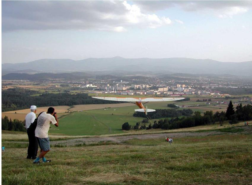
Bild eines Seglers nach dem Start, als er die Abhebe-Geschwindigkeit gerade erreicht hat. In diesem Moment ist er bereits niedriger als am Ausgangspunkt. Nur 8 Personen hatten das Gummiseil ausgezogen.
