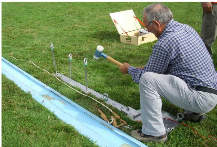
Der wichtigste Teil der Starteinrichtung ist auf einer Metallplatte. Diese wird mit langen Nägeln (30 bis 50cm lang) am Boden verankert. Auf der Platte ist eine Tostklinke, die vom "Startchef" mittels der roten Schnur in einem sicheren Abstand zum Flugzeug ausgelöst werden kann.
