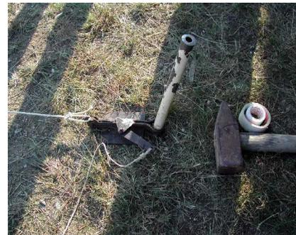
Am Hecksporn ist das Flugzeug mit einem kurzen Seil an einer Klinke eingehängt, das an einem, in die Erde getriebenen Eisenstab, befestigt ist. Die Klinke wird mit einer Schnur vom Startchef ausgelöst, so dass das Flugzeug freigesetzt wird.
