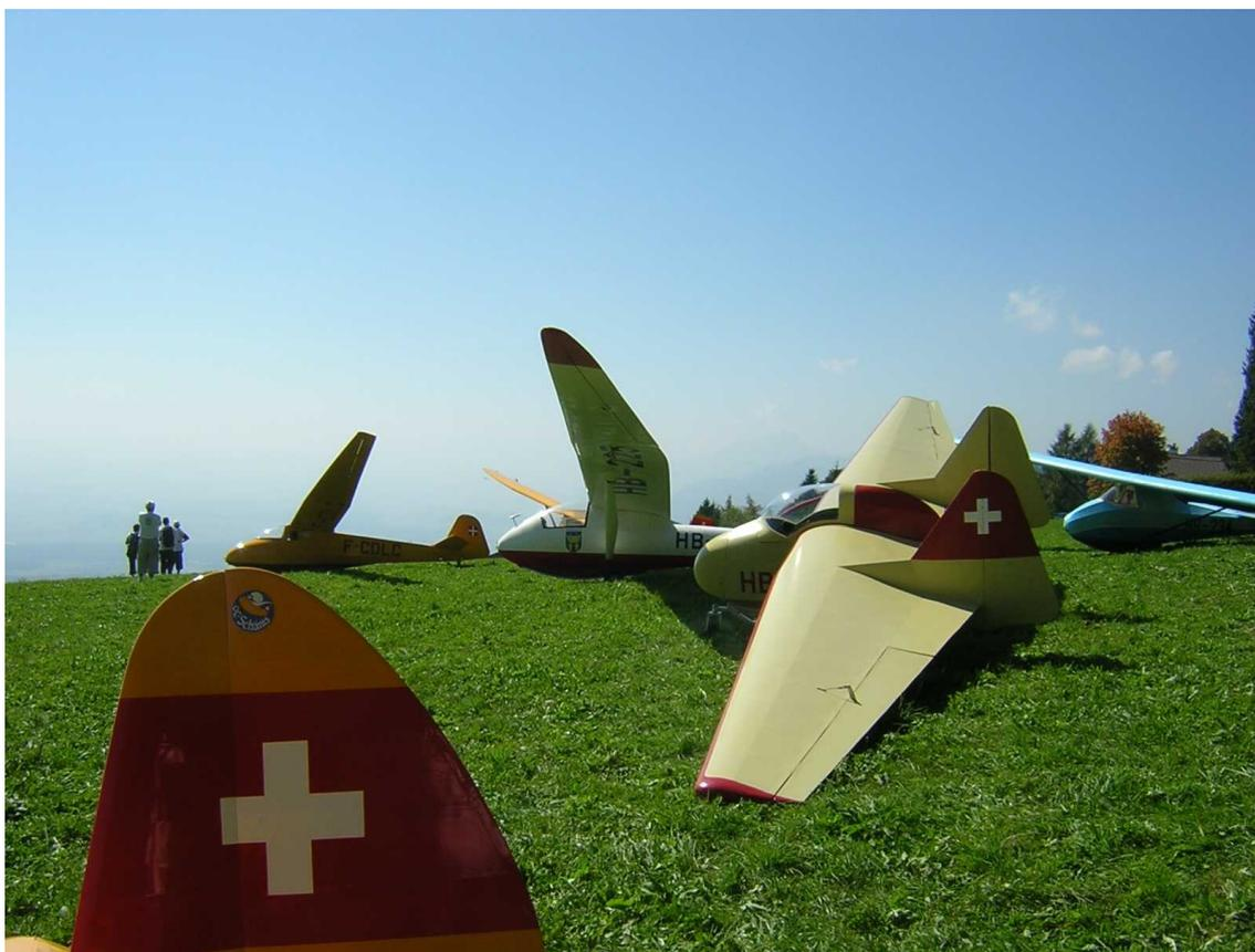
Schauen sie den herrlichen Spalinger S19 HB-225 mit seinem großen Flügel mit 17 Meter Spannweite, der 1937 gebaut wurde.
