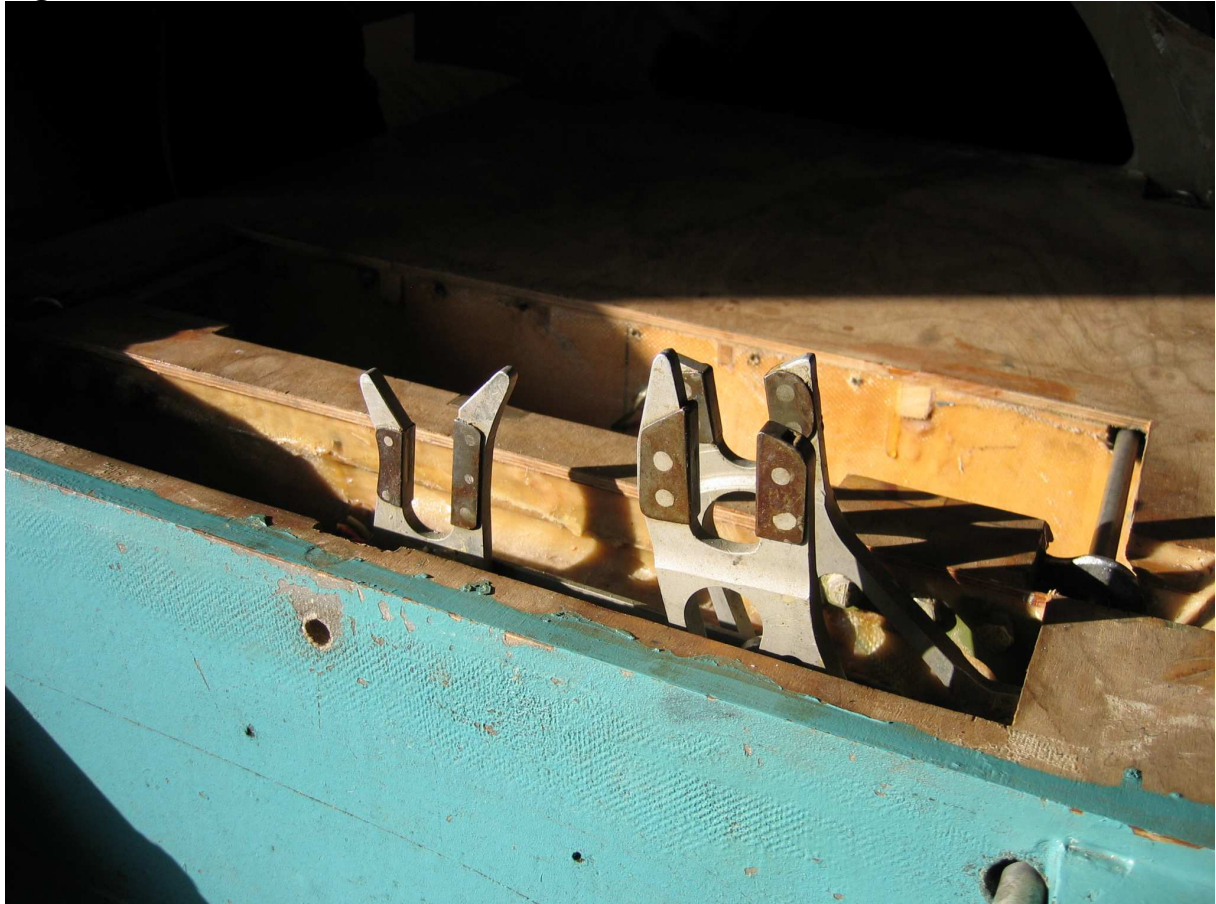
Fig. 6.8. Die Ruderanschlüsse am Rumpf © Hans Gysi
