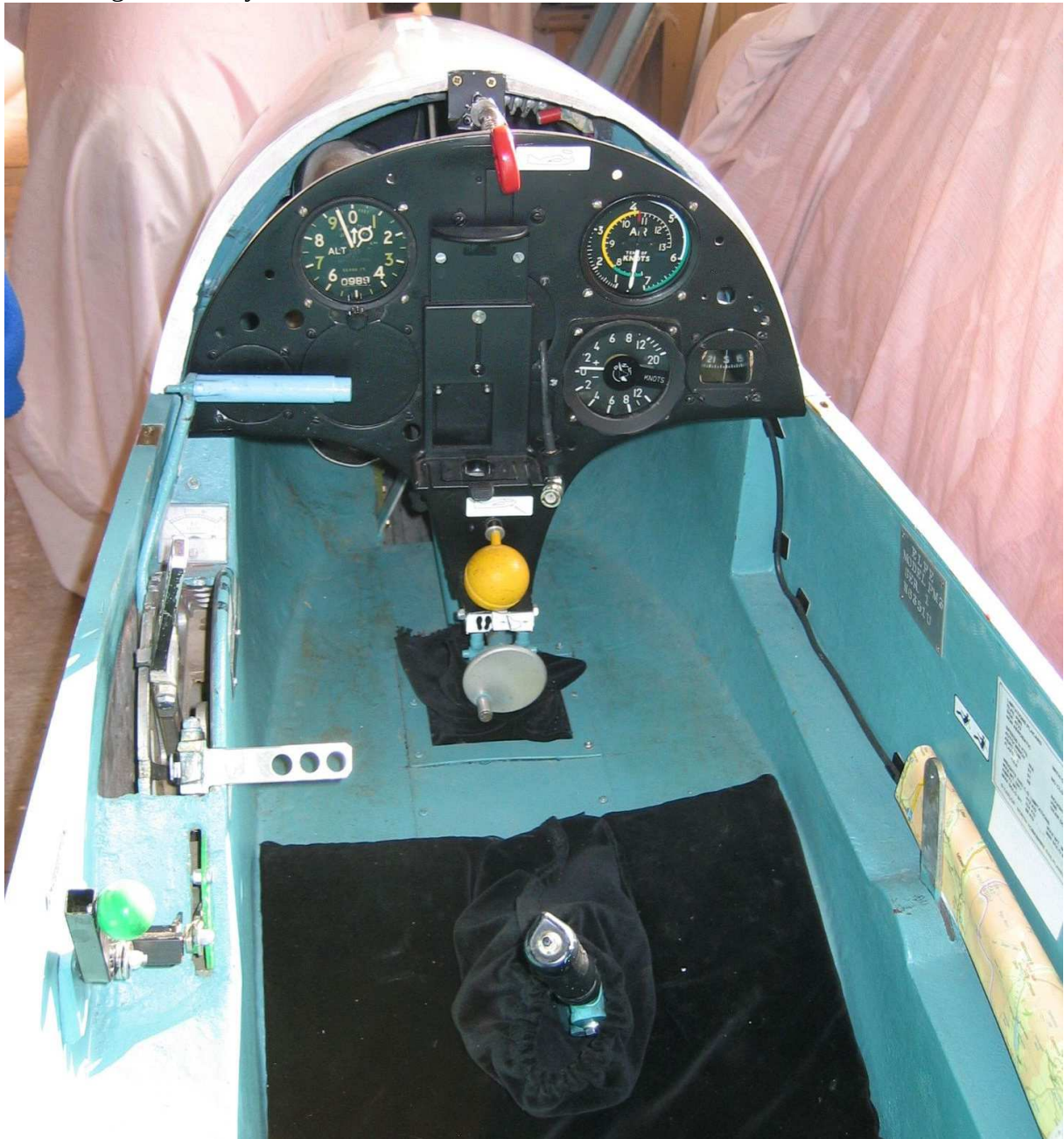
Fig. 2.8.: unten Mitte die Handkurbel, links die Bedienhebel für Wölbklappen, Rad und Trimmung © Hans Gysi
