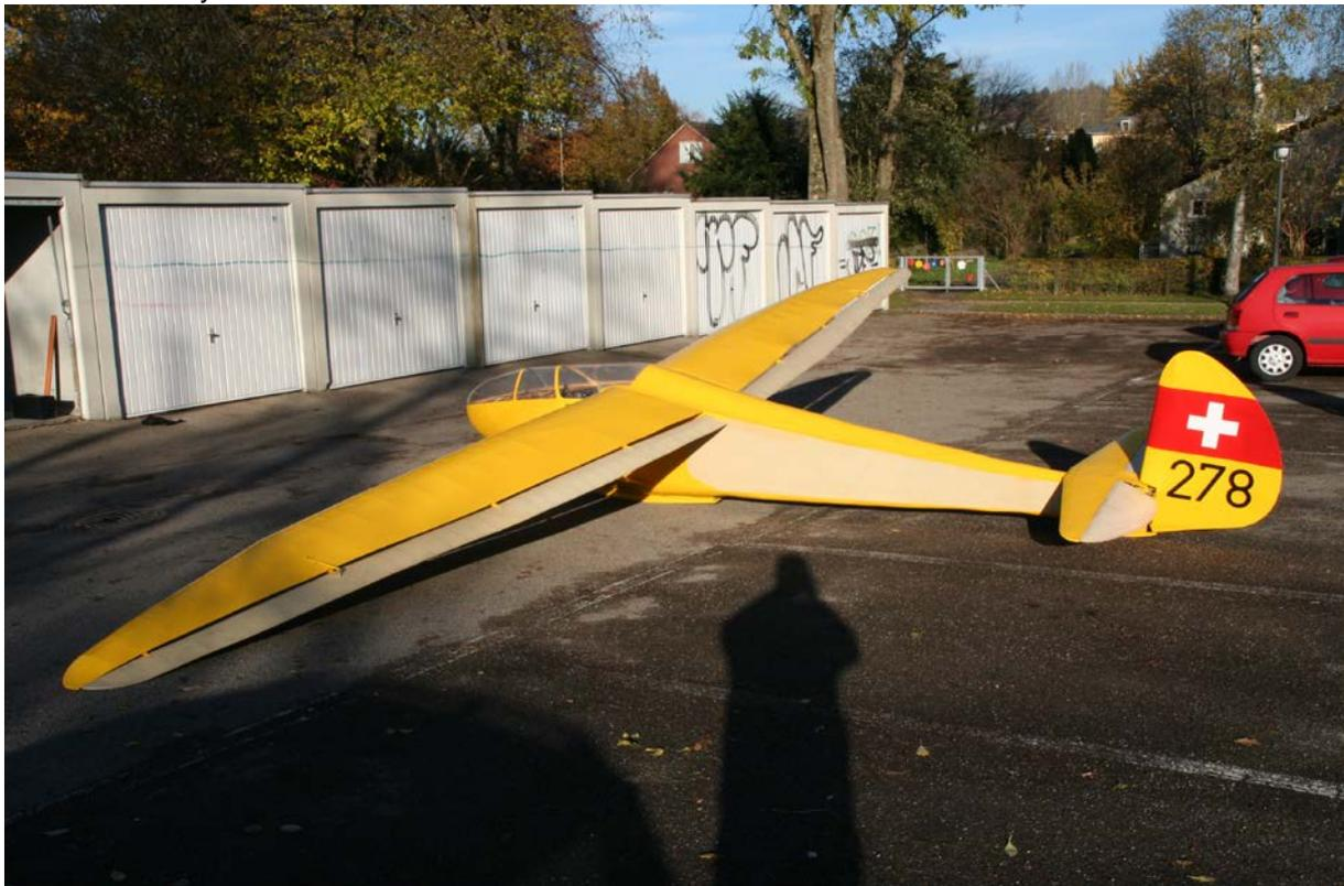
**Elfe 2** in Friedrichshafen. Mit 10,60 m Spannweite erhielt sie den Namen **11m-Elfe**. Dieses Flugzeug erzielte mit dem von 12 auf 14,1 angewachsenen Seitenverhältnis eine beachtliche Leistungssteigerung.
